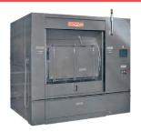
Промышленные стирально-отжимные машины «барьерного» типа с окончательным отжимом и автоматическим управлением предназначены для использования в медицинских учреждениях или в учреждениях атомной, химической, электронной промышленности и других отраслях. Конструкция машин предусматривает производить загрузку и выгрузку белья из разных зон (в помещениях, разделенных стеной) с целью соблюдения санитарно-гигиенических норм чистого белья. Таким образом, рабочие зоны разделены на «грязную» и «чистую».
