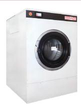
Серия «ВЕГА» – это новое поколение неподрессоренных промышленных стирально-отжимных машин с автоматическим управлением, изготовленных из качественных материалов и комплектующих на современном технологическом оборудовании. Повышенный отжим до остаточной влажности 70% позволяет исключить центрифугу из технологической цепочки и направить белье сразу в сушильную машину.
