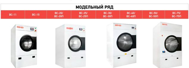
Машины сушильные предназначены для сушки белья из смешанных и хлопчатобумажных тканей, отжатых до 50% влажности. Сушильные машины выпускаются в полной комплектации: с автоматическим управлением, реверсивным вращением барабана, предотвращающим скручивание белья; сигнализацией засорения фильтра, датчиком остаточной влажности и режимом продувки холодным воздухом.
